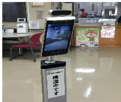
正面玄関入口に設置した顔認証検温システム
